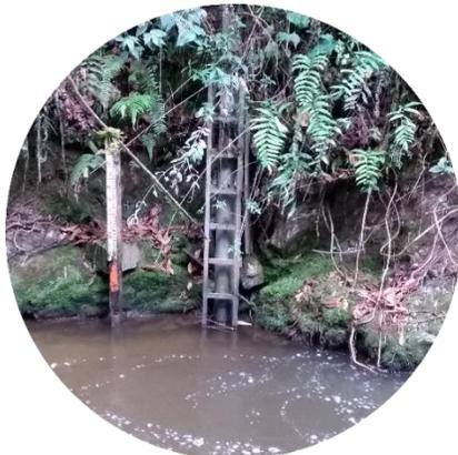
Estación Hidroclimatológica de niveles El Rasgón, se encuentra ubicada en el municipio de Piedecuesta. Captura información de la parte alta del Río de Oro. Permite el registro de las variaciones en los niveles de columna de agua para esta sección del río.
